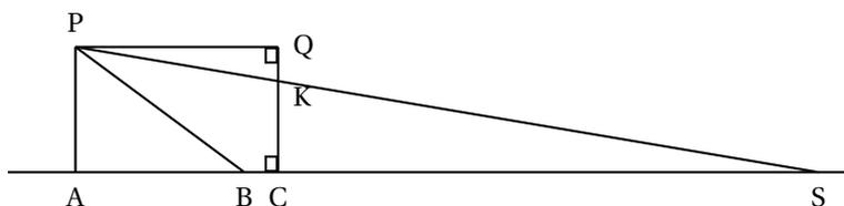
Pour que l'éclairage d'une voiture soit conforme, les constructeurs déterminent l'inclinaison du faisceau. Cette inclinaison correspond au rapport  $\frac{QK}{QP}$ . Elle est correcte si ce rapport est compris entre 0,01 et 0,015.
